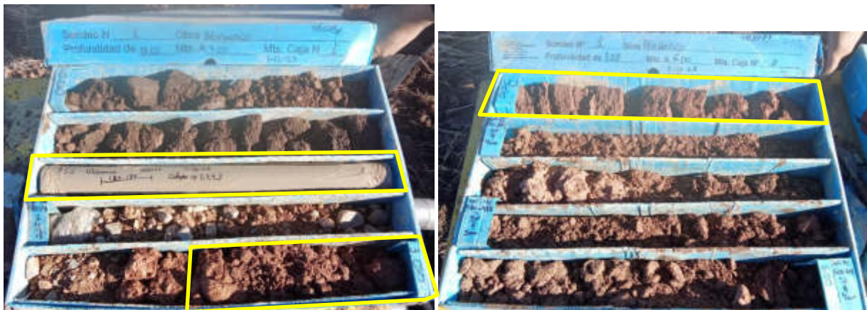
Ilustración 9: Aspecto de las arcillas cuaternarias en testigo de sondeo.
