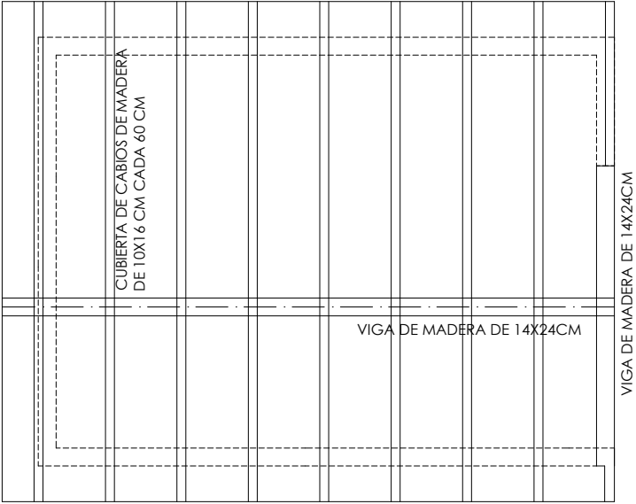
ESTRUCTURA DE CUBIERTA
