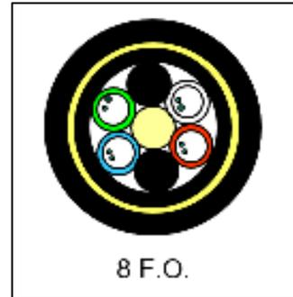
Ilustración 26. Estructura del cable óptico de multifibras tipo 8 FO-KP (Fuente: Telefónica de España. 2023).
