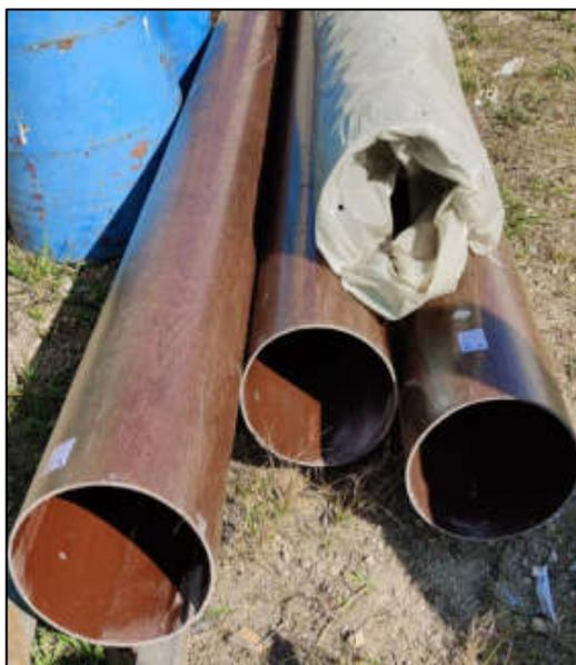
**Ilustración 25. Postes de poliéster reforzado con fibra de vidrio. (Fuente: Telefónica de España. Año 2023).**
