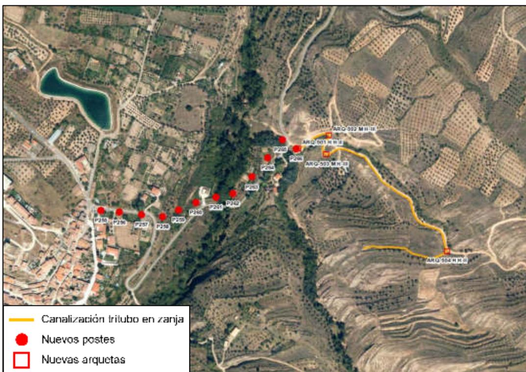
Ilustración 23. Detalle de la nueva infraestructura aérea y canalizada a instalar (Fuente: elaboración propia a partir de cartografía del Gobierno de La Rioja. Año 2023).
