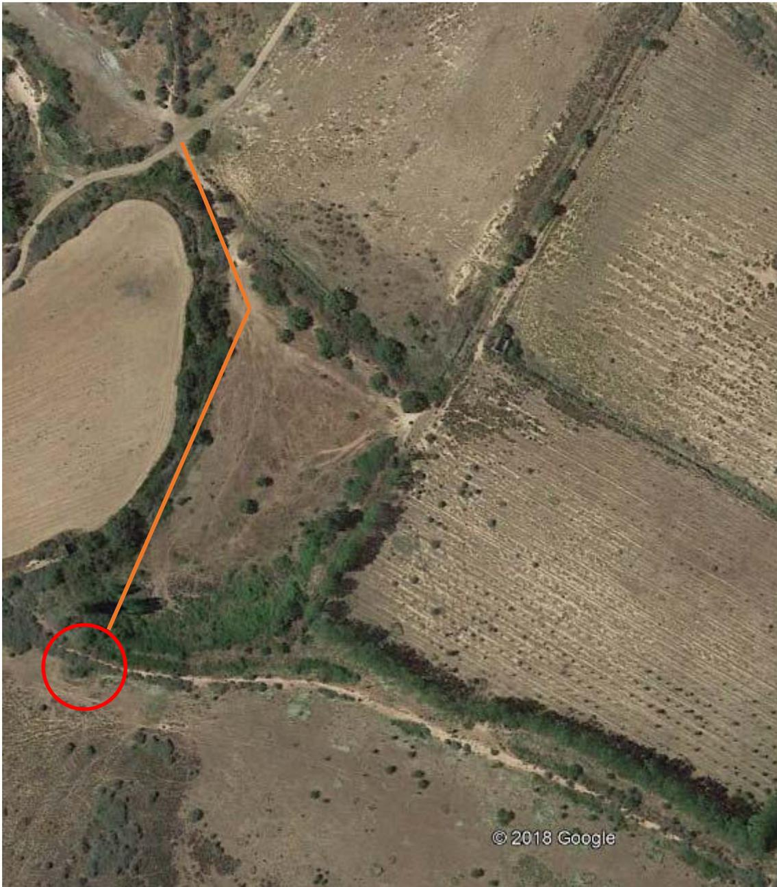
Imagen 7: Zona que hay que acondicionar para construir el camino de acceso, en total un tramo de 220 m. Parcela 200 polígono 50. Rodeado en rojo donde habrá que retirar el caballón y colocar un planchado de hormigón de unos 8,5 x 4 m de anchura.
