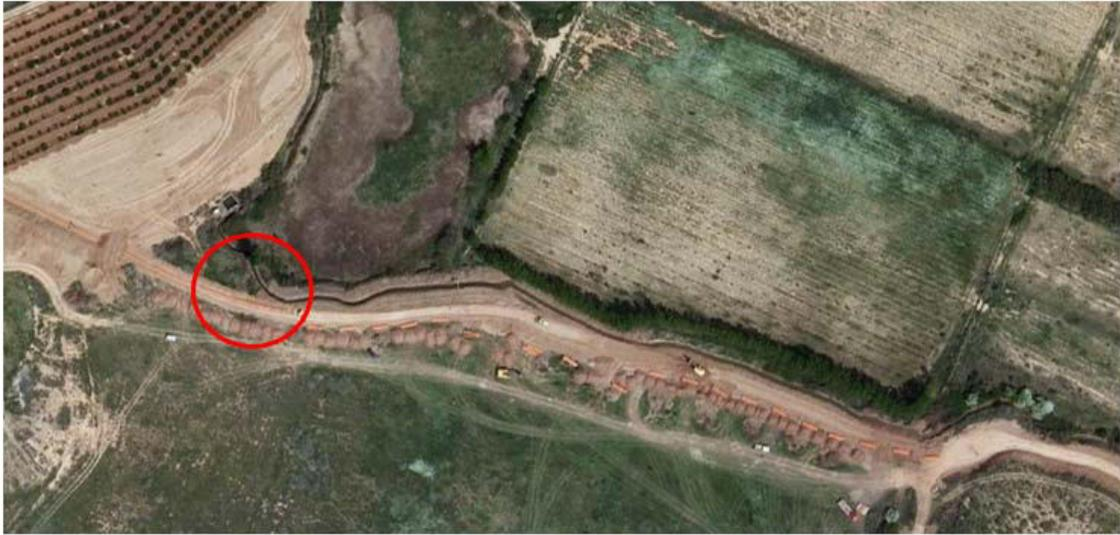
Imagen 8: Foto aérea del 2009 donde se ve cómo están instalando una tubería subterránea y marcada la zona donde se deberá colocar la plancha de hormigón para permitir el paso de los vehículos.
