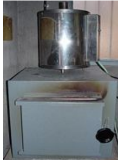
Horno de calentamiento del cilindro para fundir la cera, y del crisol que es el recipiente en el cual se funde el metal.
