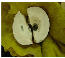
Separación del revestimiento de la pieza colada o descilindrada.
