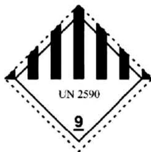
Etiqueta de peligro para el transporte de mercancías peligrosas para el caso del asbesto blanco.
