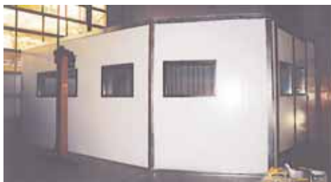
Cabina de aislamiento térmico.
