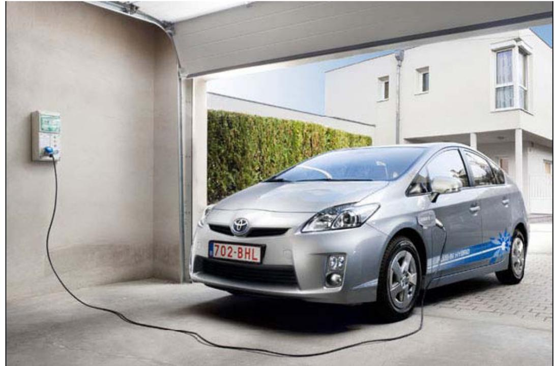
La autonomía de conducción en modo eléctrico es de **25 km** y en modo híbrido puede alcanzar más de 1.200 km con un consumo medio de **2,1 l/100km** y unas emisiones de CO2 de sólo **85 g/km**.
