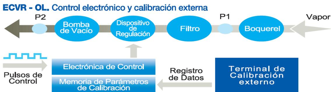
Ilustración 4.- ESQUEMA DE UN SISTEMA ECVR OL PARA LA RECUPERACIÓN DE FASE II. FUENTE: TOKHEIM. Punto 1: Grupo Motor de la Bomba de recuperación. Punto 2: Dispositivo de control del volumen recuperado.
