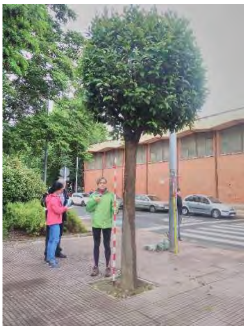
Figura 17. Medida de índice de área foliar (LAI) en un ejemplar de aligustre con el analizador de dosel vegetal LI-COR LAI-2200C.
