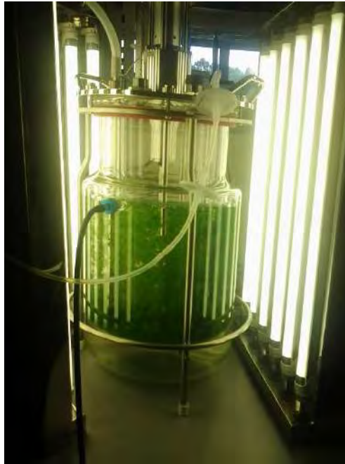
Figura 3. Fotobiorreactor utilizado en el cultivo del clon del musgo Sphagnum palustre L.
