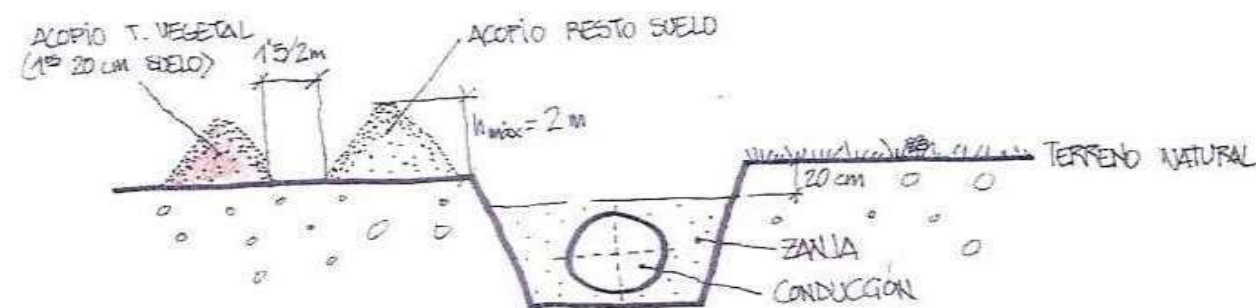
Croquis representativos de la forma de realizar los acopios de suelo. Sección
