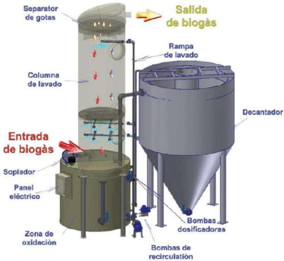
Esquema de equipo de desulfuración
