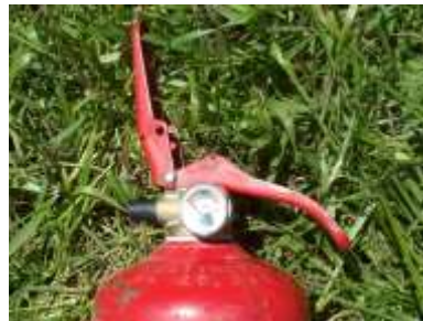
Extintor sin anilla de seguridad
