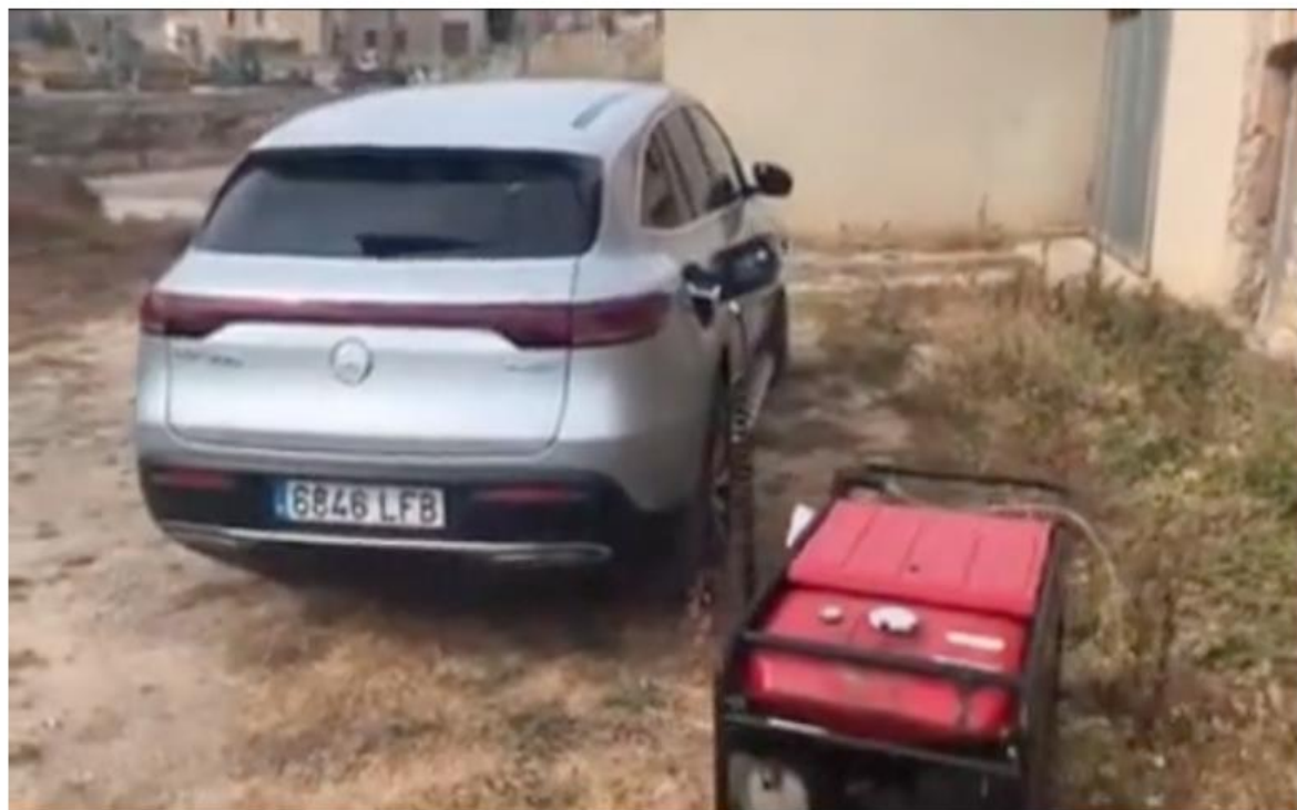
El Mercedes-Benz EQS SUV cargando con un grupo electrógeno de gasolina.
