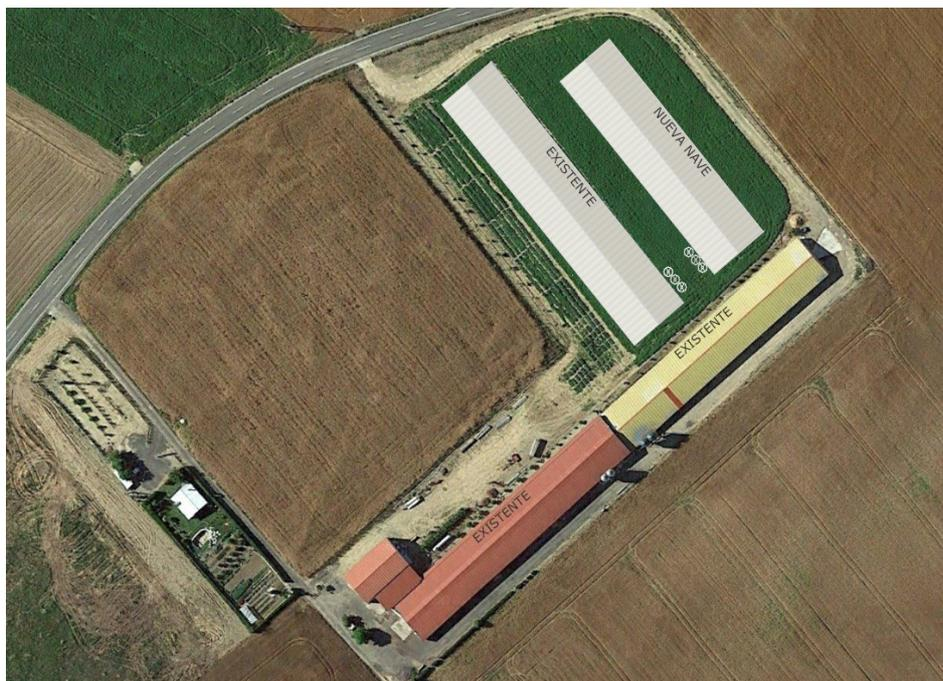
La nave que se pretende ejecutar tendrá una superficie de 1.600 m<sup>2</sup> construidos en planta. Será de estructura metálica y cerramiento con paneles tipo sándwich.
