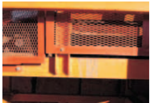
Detalle de las protecciones de los elementos móviles
