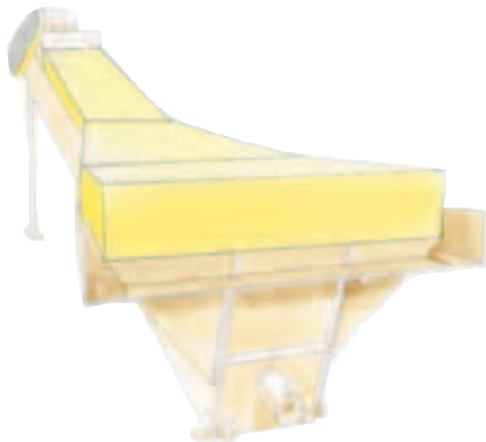
Preparador mecánico de hélice formado por un tanque hueco de inclinación ascendente con un tornillo helicoidal (o paletas) de rotación lenta. Nota: Para una mayor claridad, la malla no se muestra en el dibujo.
