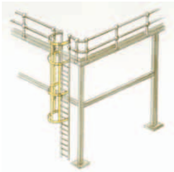
Escaleras permanentes verticales fijas (Escalas).
