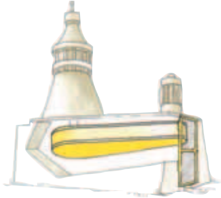
Tritadora giratoria con mecanismo de accionamiento horizontal y motor situado en posición vertical, impulsada por correas de transmisión.
