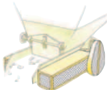
Alimentador oscilante, constituido por un brazo excéntrico que acciona una bandeja atrás y adelante por medio de un motor eléctrico.
