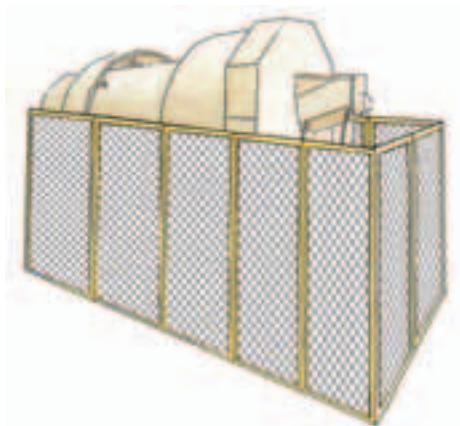
Trómel desenlodador sobre ruedas neumáticas, accionado por un motor eléctrico mediante una caja de transmisión.
