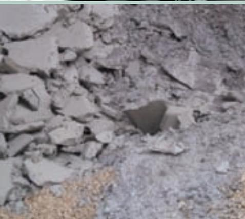
Minimización de residuos de hormigón (de arriba a abajo): limpieza de hormigoneras; separador de paletas para los residuos de las hormigoneras; torta de sólidos (cemento y áridos)
