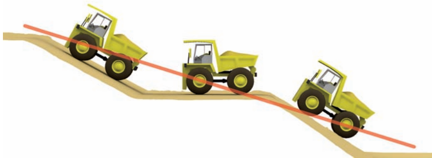
FIGURA 21 EFECTOS DEL TRAZADO EN ALZADO DE LAS PISTAS
