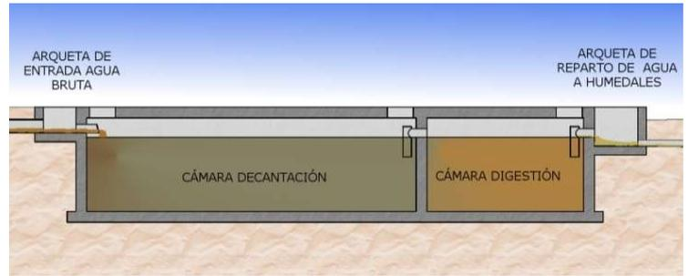
La arqueta de entrada dispone de un vertedero metálico para alivio de los caudales excedentes o como By-Pass del proceso cuando se realizan labores de mantenimiento, a través de una tubería de PVC Ø 315 mm.
