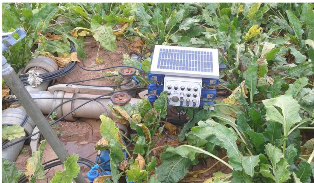
Dos de los equipos de automatización GPRS utilizados en los ensayos en 2015 (página anterior y foto superior).
