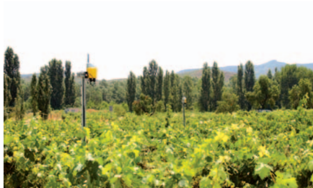
Nodos inalámbricos encargados de enviar los datos recogidos por los sensores.
