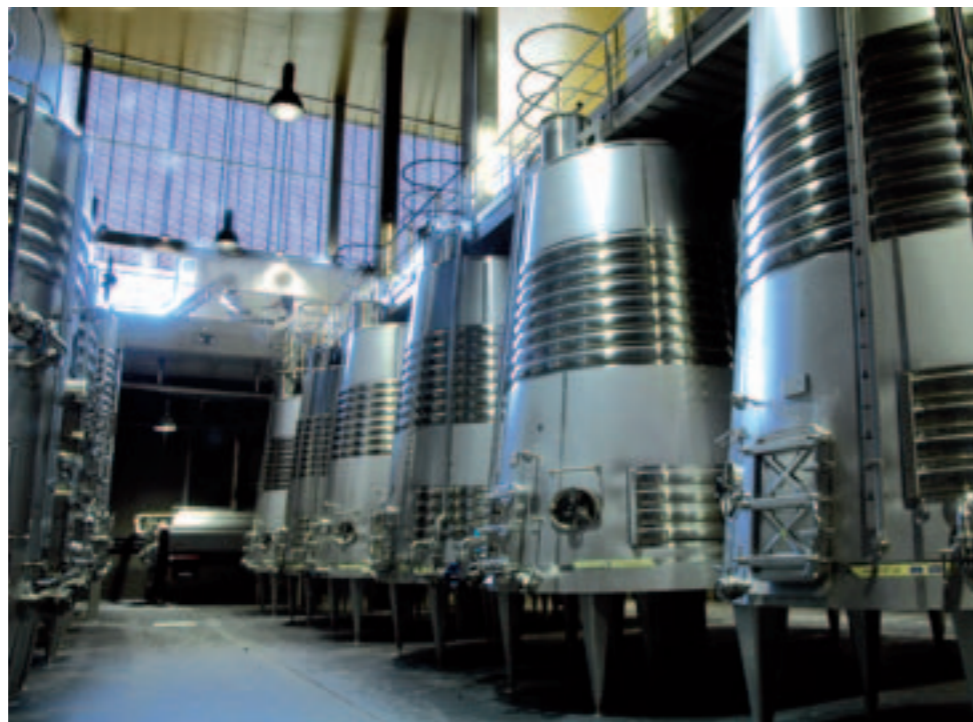
El control de fermentaciones se realiza con energía geotérmica, al igual que toda la climatización de los edificios.
