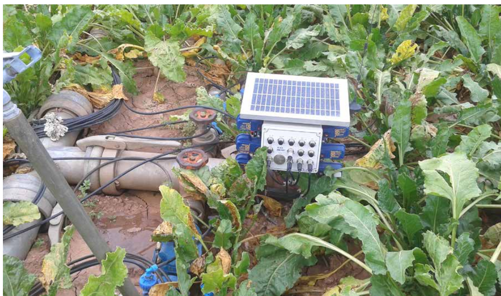
Dos de los equipos de automatización GPRS utilizados en los ensayos en 2015 (página anterior y foto superior).
