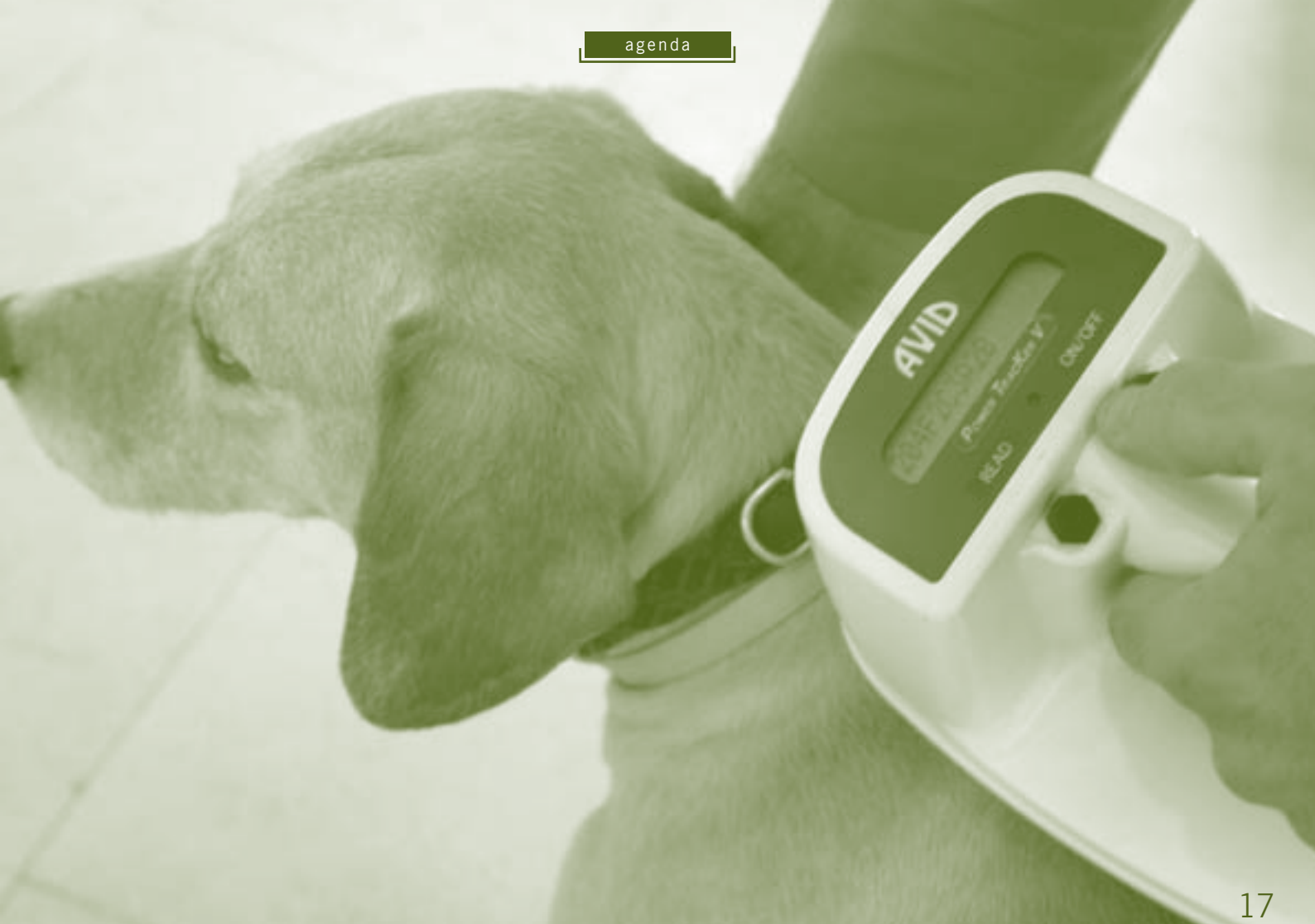
Aparato lector del número de identificación que contiene el chip.
