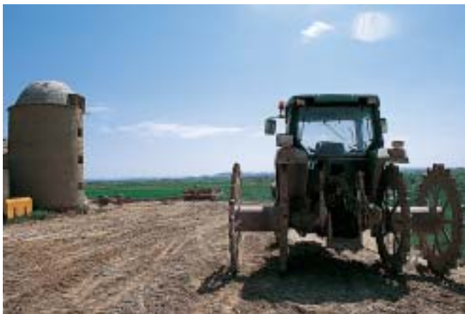
Tractor con ruedas especiales que permiten realizar las labores en las tierras anegadas.
