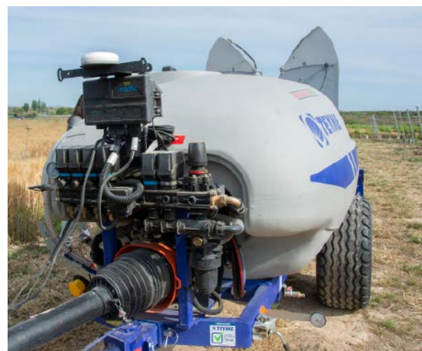
Dispositivos de tecnología de dosificación variable: GPS, electroválvulas, etc.
