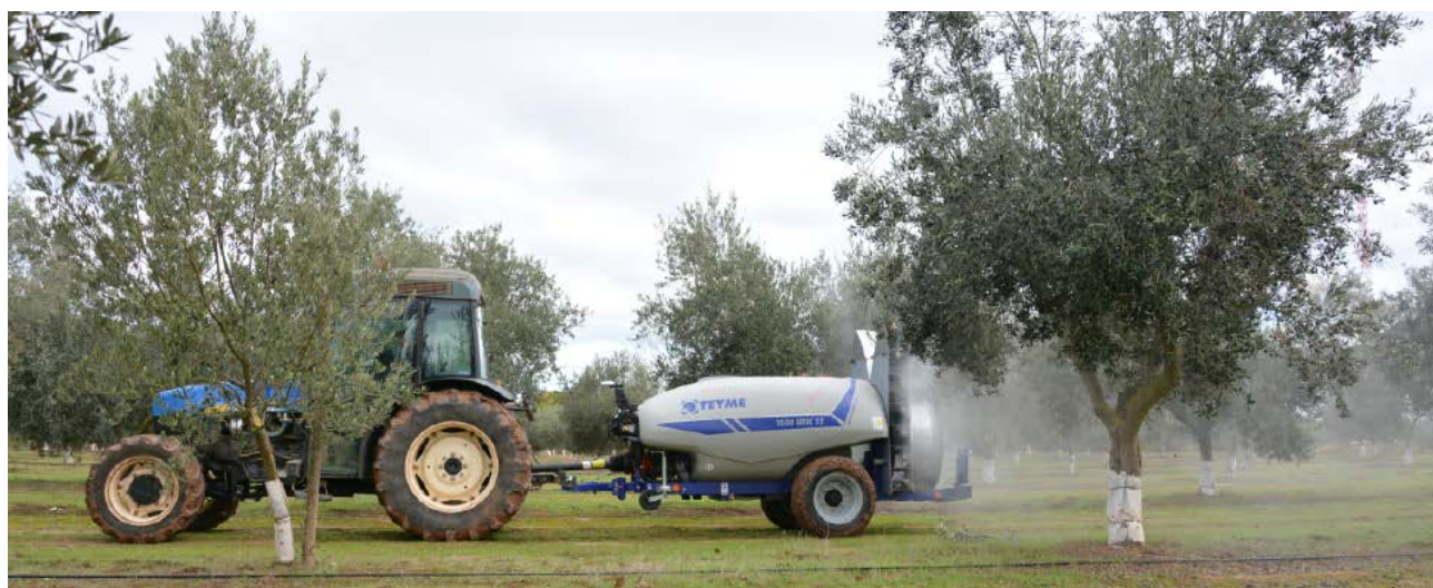
Aplicación de fitosanitarios en olivo con equipo de precisión.
