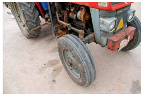
Neumático con banda de rodadura desgastada.
