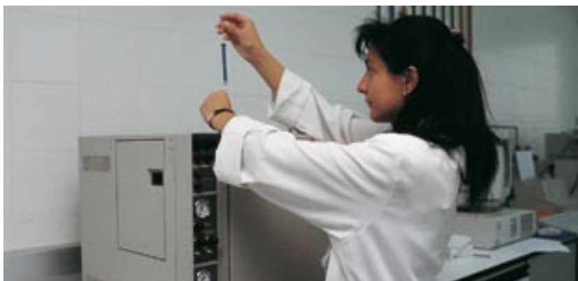
Cromatógrafo de gases, utilizado en el ensayo para analizar los compuestos volátiles. / Ch. Díez
