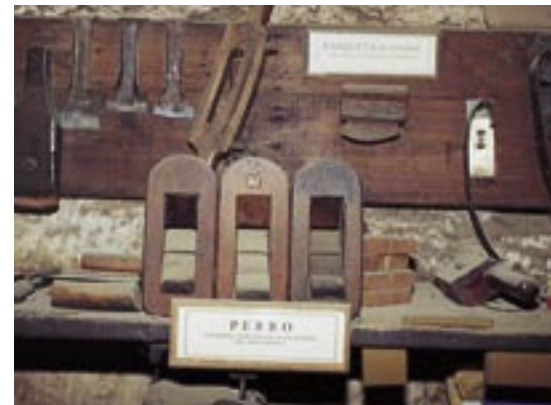
Útiles de tonelería con los que se fabrican y reparan todas las barricas de la bodega.
