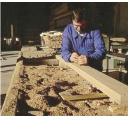
Serrería en el patio de Muga donde se preparan las duelas para fabricar las barricas y las tinas de roble.
