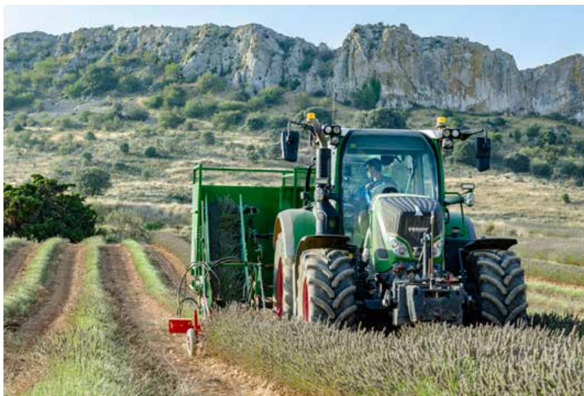
La cosechadora corta los tallos florecidos y los deposita en el cajón de carga.
