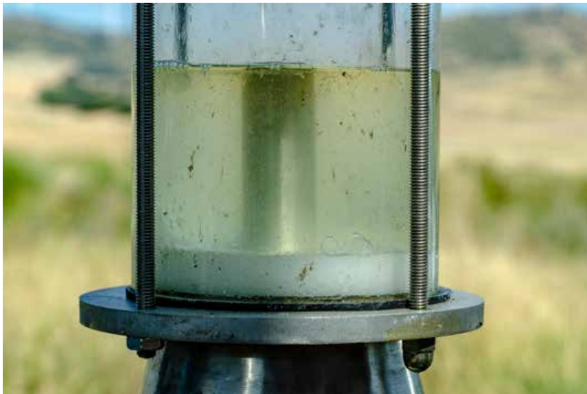
Vaso florentino donde, por densidad, se separa el hidrolato del aceite esencial, que queda en la parte superior. De ahí, se envasa para su venta.
