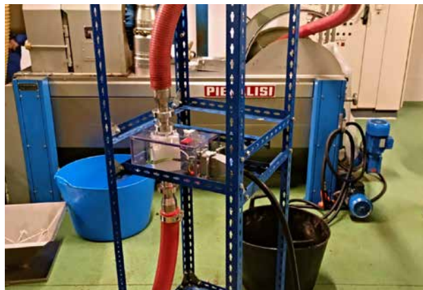
Tecnología de pulsos eléctricos durante el proceso de extracción del aceite.
