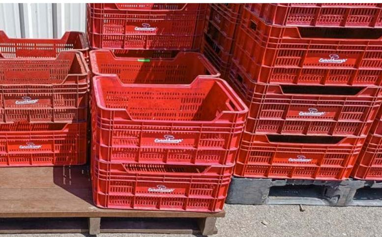
como con métodos químicos y desinfectantes, ya que, al ser un material impermeable, no permite la introducción de parásitos ni bacterias. Tiene, además, mayor durabilidad y resistencia a productos químicos y ofrece mayor seguridad en la manipulación debido a la ausencia de astillas y clavos. Por otro lado, no necesita tratamientos fitosanitarios o de fumigación y posee mayor resistencia a las condiciones climáticas adversas.
