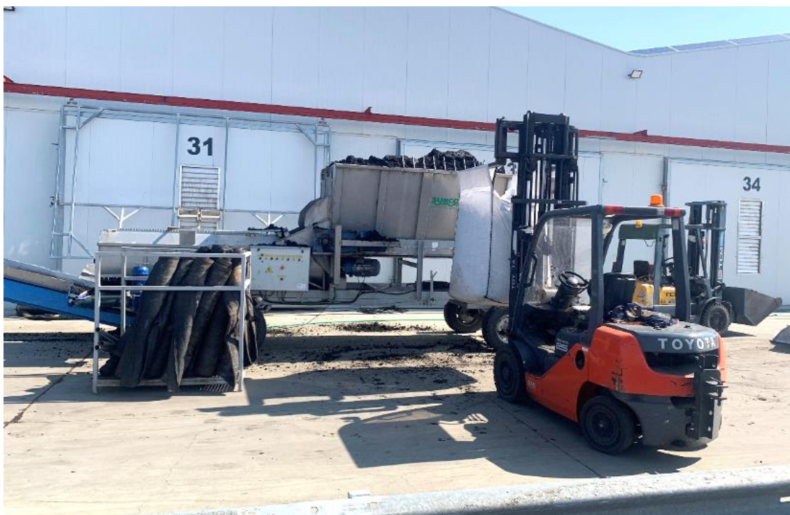
Tolva de recepción de turba
