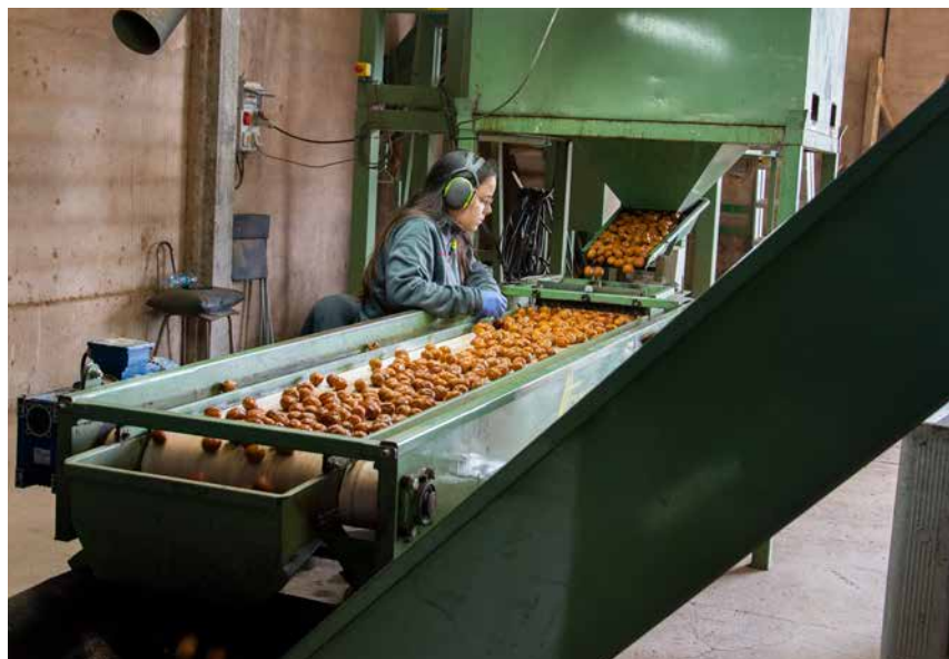
Selección de las nueces para quitar los frutos con defectos en las instalaciones de José Luis Sopranis.
