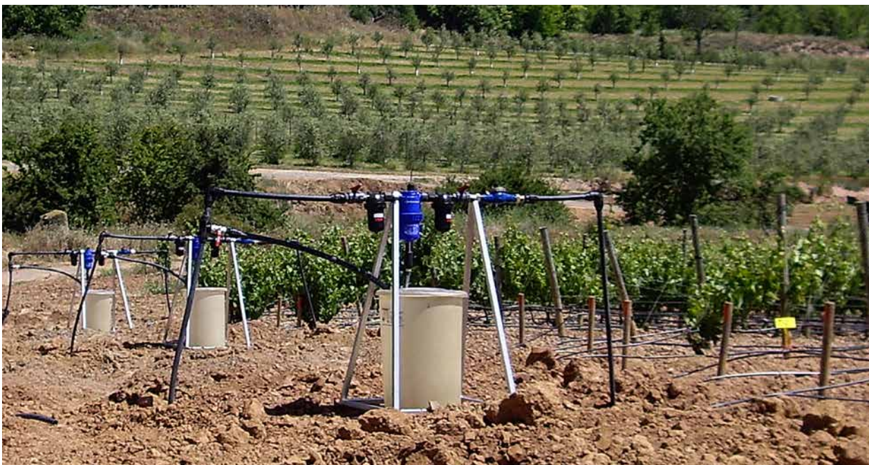
Figura 4. Sistema de fertirrigación utilizado para ensayos sobre la nutrición de la vid.
