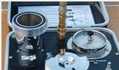
Cámara de presión: potencial hídrico.
