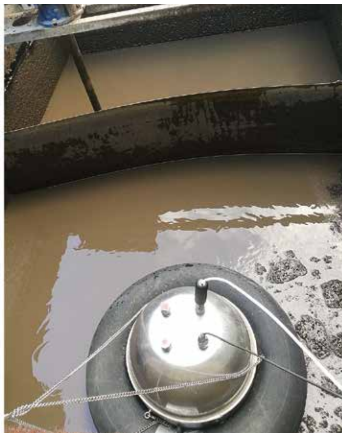
Planta de lodos activados implementada en la bodega ubicada en Ribadavia. Izquierda: medición de gases en el reactor biológico. Derecha: medición de gases en el tanque de lodos.
