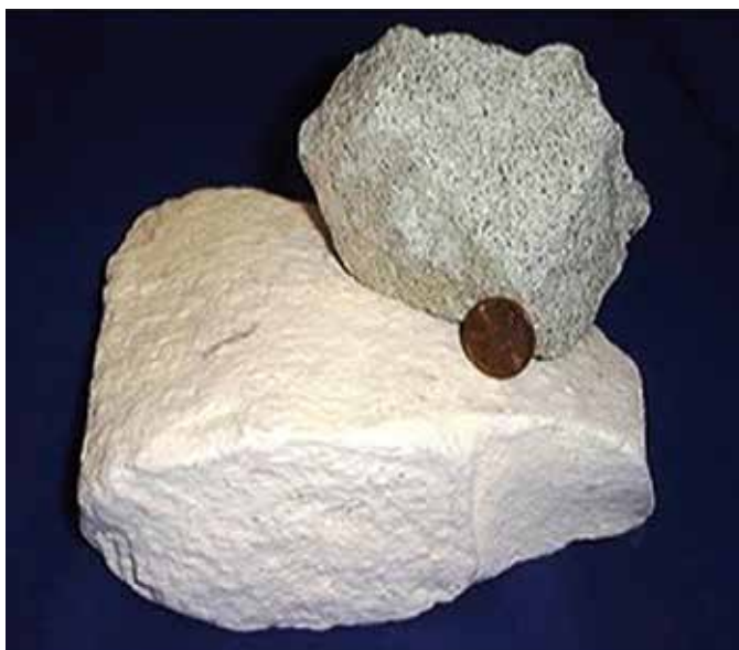
Figure 10. Une zéolithe, ou zéolite, est une roche formé d'un squelette microporeux d'aluminosilicate, dont les espaces vides permettent d'optimiser l'adsorption et les processus de biodégradation du système racinaire des roseaux (Source Zeofito®).
