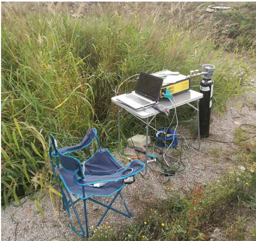
Planta piloto WETWINE. Montaje de la campana para la medición de gases en el humedal horizontal (HH).
