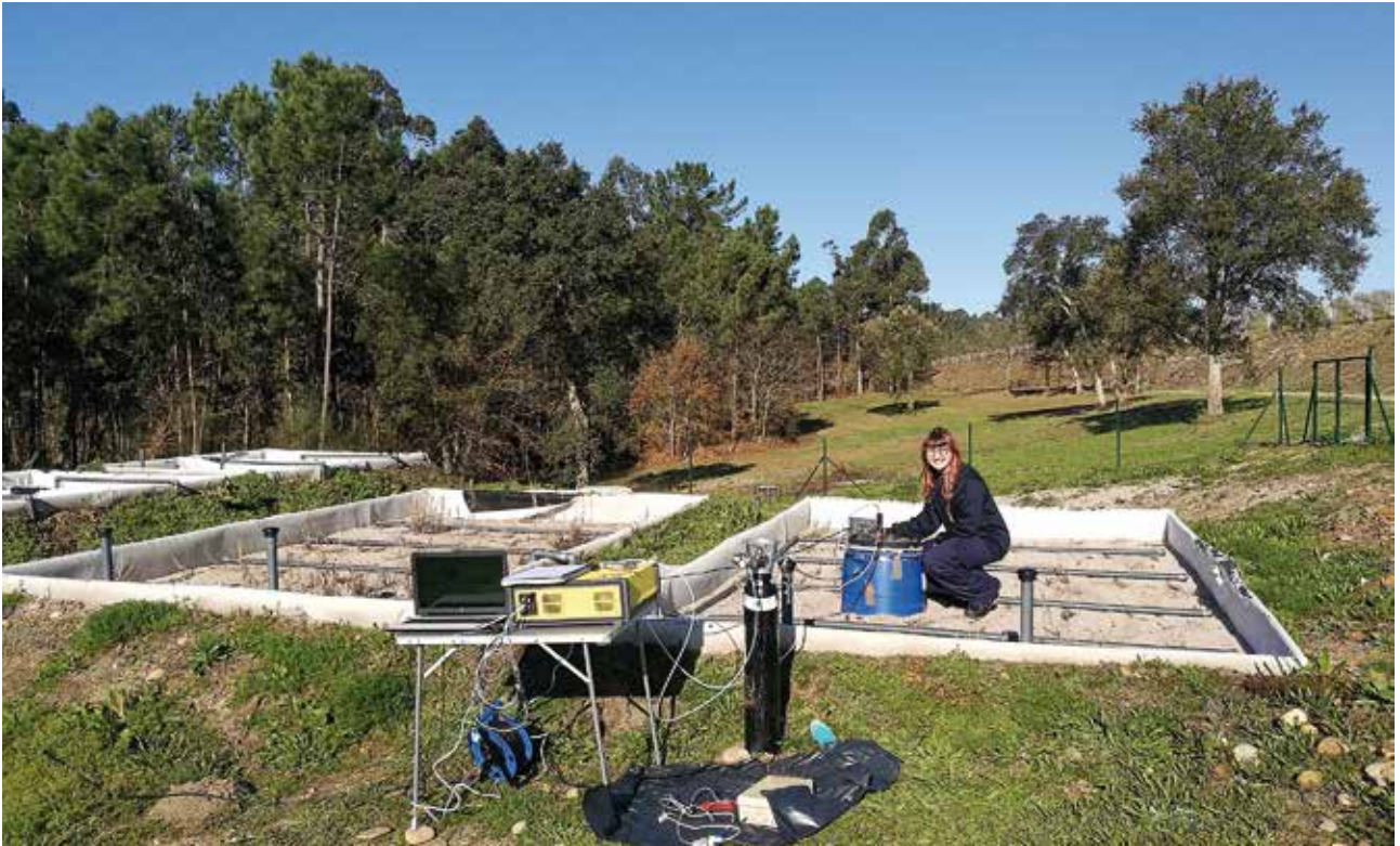
Planta piloto WETWINE. Montaje de la campana para la medición de gases en un humedal vertical (HV).
