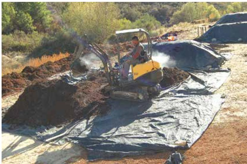
Figura 2. Revolvimento e cobertura das pilhas de compostagem com tela de polipropileno.
