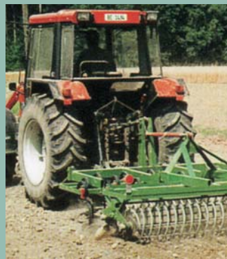
Trabajos de descompactación: escarificado y preparación superficial
