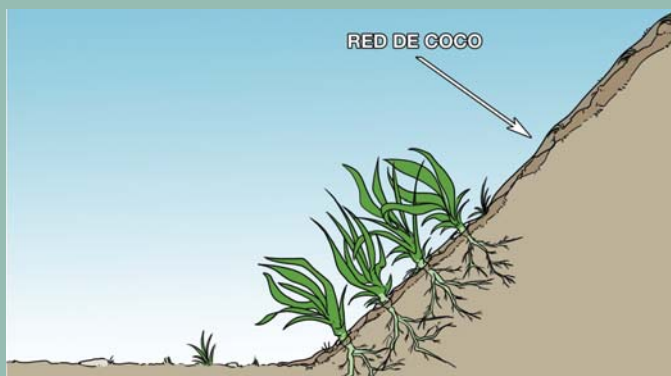
Empleo de biorrollos para insertar esquejes
