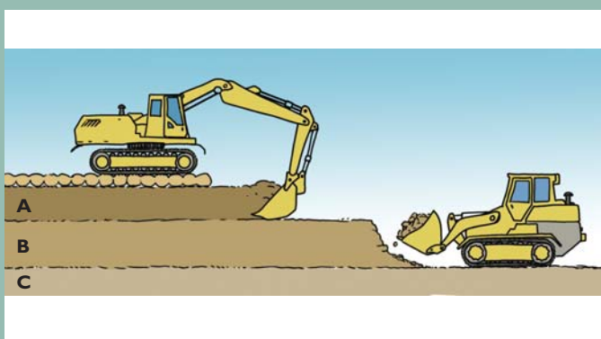
Retirada en paralelo de los horizontes A y B
