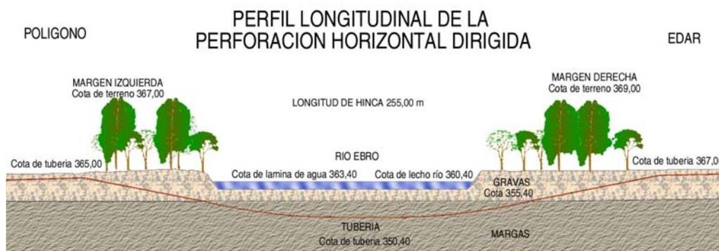
Dada la existencia de gravas en el lecho del río, la perforación hubo de realizarse por debajo de éstas a más de 10 m de profundidad.
