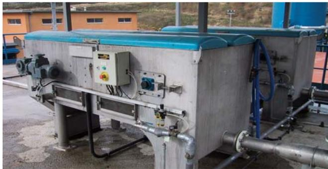
El fango concentrado se almacena en un depósito de 260 m<sup>3</sup> de capacidad desde el que se alimentan dos centrifugas, con capacidad para tratar un caudal de 25 m<sup>3</sup>/h, y que permiten obtener un fango deshidratado, con un 25% de materia seca.
