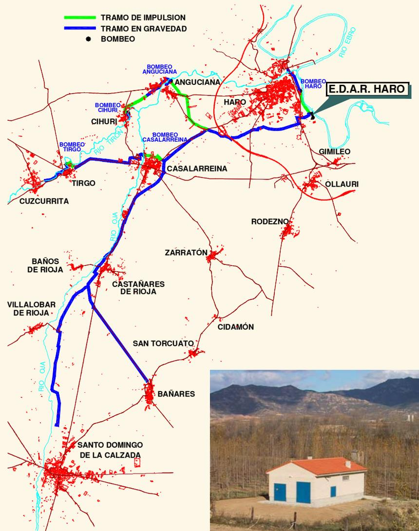
La red de colectores se estructura con un emisario principal, que discurre enteramente por gravedad entre Santo Domingo de la Calzada y la depuradora, un ramal para conducir hasta ese colector el vertido de Bañares y un conjunto de tramos en gravedad que canalizan los vertidos hasta las estaciones de bombeo con las que se impulsan al emisario principal todos los vertidos de la cuenca del Tirón.
