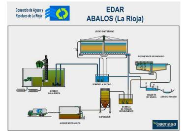
La depuradora está automatizada, de forma que los procesos se regulan para adaptar en cada momento el funcionamiento de la planta a las necesidades reales de tratamiento. Así, está regulado automáticamente el funcionamiento de las bombas, la recirculación de fangos y el aporte de agua al lecho, incorporando además un sistema de alarmas para detectar los posibles fallos de funcionamiento de los equipos.
