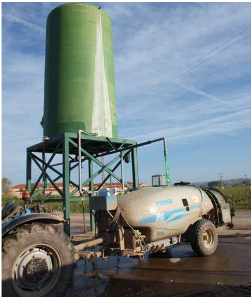
Punto de toma de agua.
