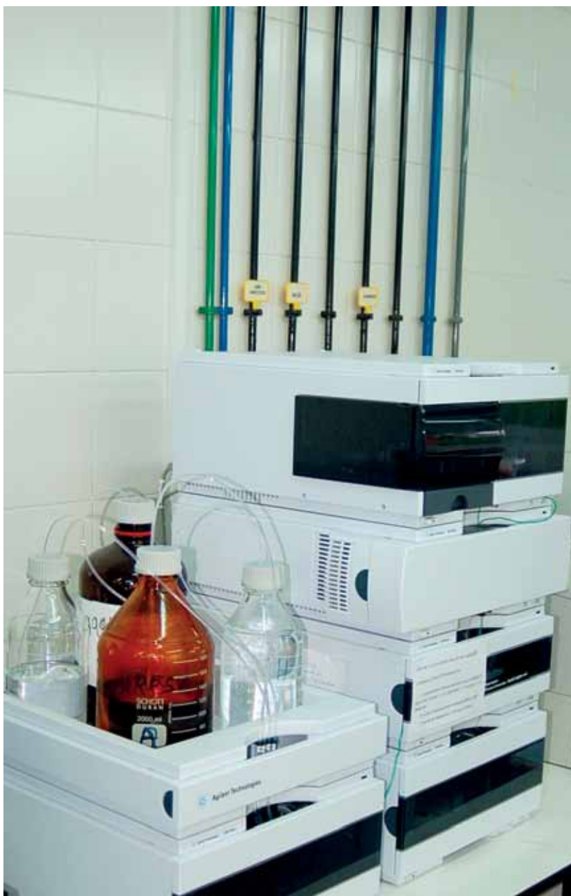
Cromatógrafo de líquidos (HPLC), equipo utilizado para analizar los aminoácidos. / Michel López de Dicastillo
