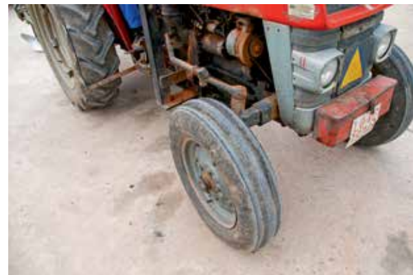
Neumático con banda de rodadura desgastada.
