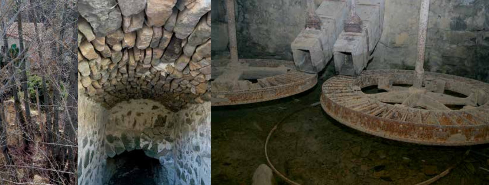
Al fondo del cárcavo (a la izda.) se encuentran los rodeznos que movían el molino al recibir el agua por las botanas. / Cedita por Magdalena Martínez
