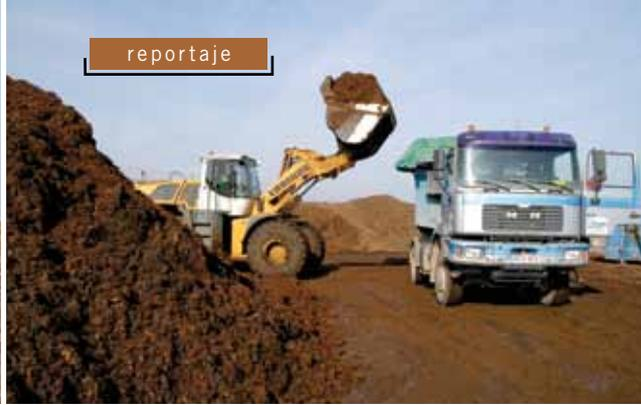
Un camión carga el sustrato sin compostar, recién salido del trommel.
