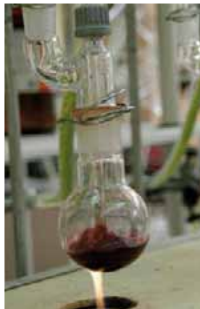
Matraz para determinar el sulfuroso del vino.
